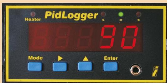
Contrôle électronique de la température avec régulateur PID, et minuterie multi-fonctions.
