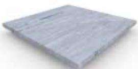
**Mipolam ROBUST EL7** est un revêtement vinyle homogène dissipateur compact disponible en rouleau et en dalle. Ce revêtement est en permanence antistatique (< 100 V). Le produit calandré et compacté est traité dissipateur permanent  $10^6 \leq R_t \leq 10^8$  (EN 1081) et est conforme à la norme EN 649.
