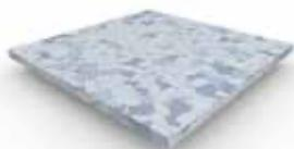
**MIPOLAM TECHNIC EL5** est un revêtement vinyle homogène conducteur compact disponible en dalles. Les 2 mm d'épaisseur du produit incorporent des granulés colorés dans la masse enrobés de carbone conducteur calandré et compacté. Ce revêtement est en permanence antistatique (< 20 V). Ce revêtement agit comme un conducteur électrique permanent  $10^6 \leq R_t \leq 10^6$  (EN 1081) et est conforme à la norme EN 649.
