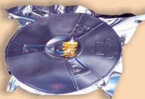
Sac barrière scellé avec une dépression trop forte
