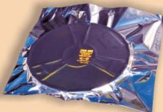
Sac barrière scellé avec une légère dépression
