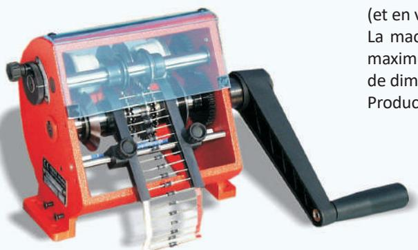
La machine SUPERFORM/A coupe et plie les pattes des composants axiaux en bande (et en vrac avec l'option alimentateur vrac). Motorisation en option (voir page 10). La machine est solide et compacte : elle peut admettre des pattes de diamètre maximum 1,3mm, voire 1,4mm en variante. Les réglages permettant de changer de dimensions de formage ou de coupe sont rapides et simples. Production: jusqu'à 40000 pièces/heure
