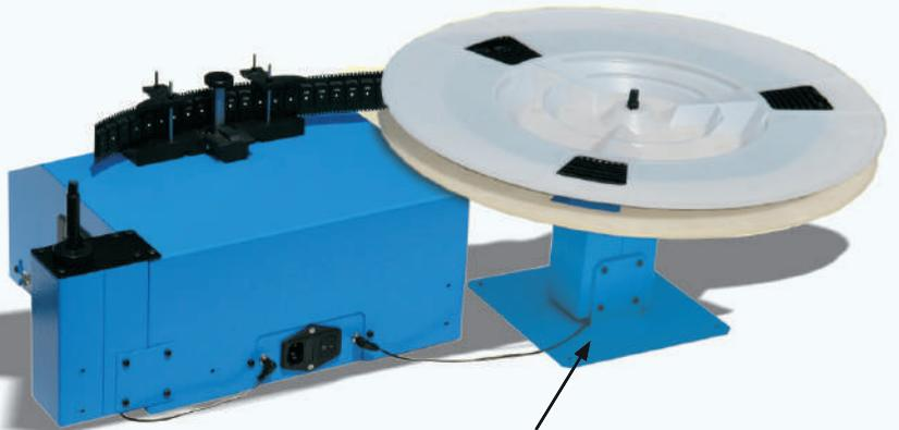
Support pour bobines avec diamètre >400mm
