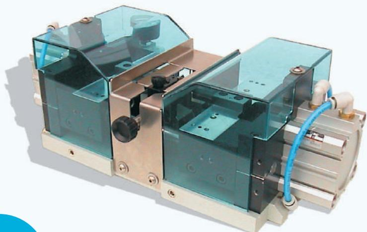
La machine pneumatique SUPERCUT/TS1 coupe et forme les pattes des composants radiaux en vrac.
