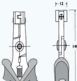
Outil spécial pour préformer avec patte centrale décalée de 3.81mm.
