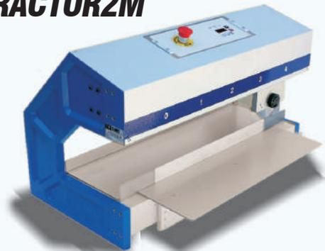
TRACTOR2 sépare les circuits imprimés pré-rainurés de petite ou de grandes dimensions, la longueur de coupe est 450mm. Le circuit est placé sur la lame linéaire, et on fait glisser la lame circulaire sur la rainure supérieure qui est actionnée manuellement ou motorisée. La distance entre la lame circulaire et la lame linéaire est réglable.
