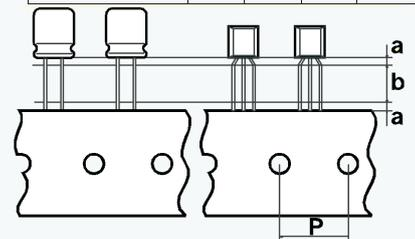
La machine SUPERCUT coupe les pattes des composants radiaux en vrac. Au moyen d'un porte-bobine spécial mod.BR3 (fourni en option), elle peut aussi couper les pattes des composants en bande.
