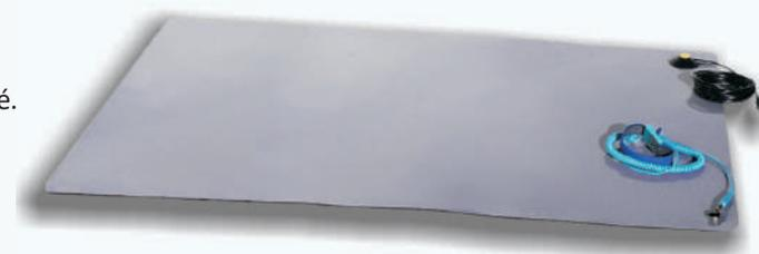
**Kit esd portable** Très utile durant les interventions de dépannage et d'après-vente car grâce à ce kit, on crée une petite zone ESD protégée. Le kit est composé d'un tapis (avec 2 poches) équipé de 1 pression mâle diam.10mm, d'un cordon de mise à la terre de 1,5m et d'un bracelet réglable avec son cordon. L'ensemble est livré plié dans une pochette.
