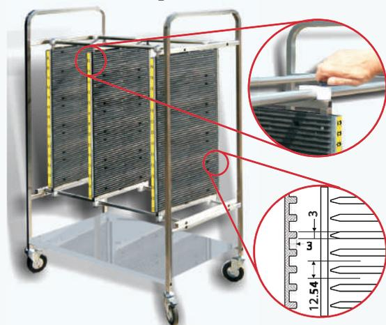
Un magasin porte-cartes mobile de grande capacité. Panneaux coulissants facilement réglables, avec 84 guides horizontaux au pas de 12.54mm.
