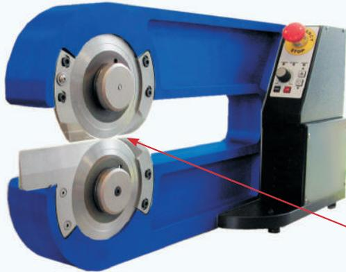
La machine TRACTOR à dépanneliser les cartes sépare les circuits imprimés pré-rainurés de façon rapide et économique. La structure en aluminium, compacte et stable, occupe un espace réduit.
