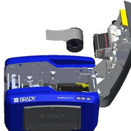
5. Faites rouler le ruban d'étiquette sous et à travers les guides du média, jusqu'à ce que le ruban couvre le rouleau noir.
