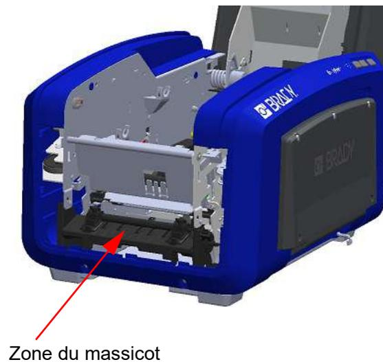
8. Pour ramener le rouleau noir dans sa position initiale, alignez les languettes avec les encoches d'insertion puis enclenchez le rouleau en place.
