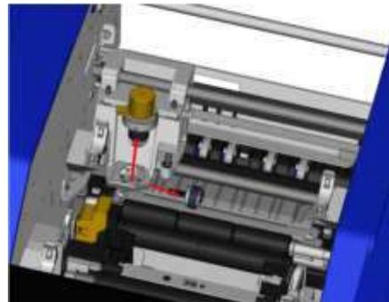
3. Utilisez un tournevis magnétique (de sorte que les vis ne tombent pas dans l'imprimante) pour retirer la vis du guide supérieur.
