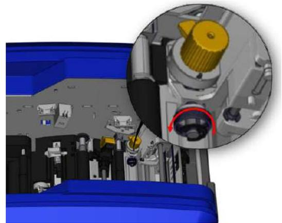
6. En utilisant une tige humectée d'alcool isopropylique, dépoussiérez la zone où la lame ressort.
