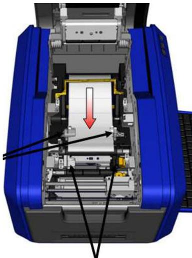
6. Pincez le levier de réglage du ruban et faites glisser les guides du support jusqu'à ce qu'ils s'alignent aux bords de la pellicule du ruban.
