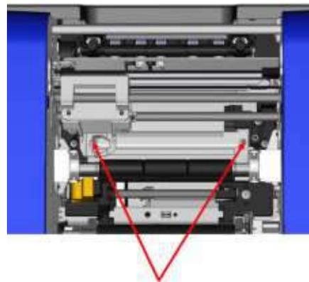
11. Coincez le bord gauche du guide supérieur sous le chariot du module de la lame de découpe, au-dessus du coussinet de découpe, en alignant l'orifice du côté droit à l'orifice de la vis vide.
