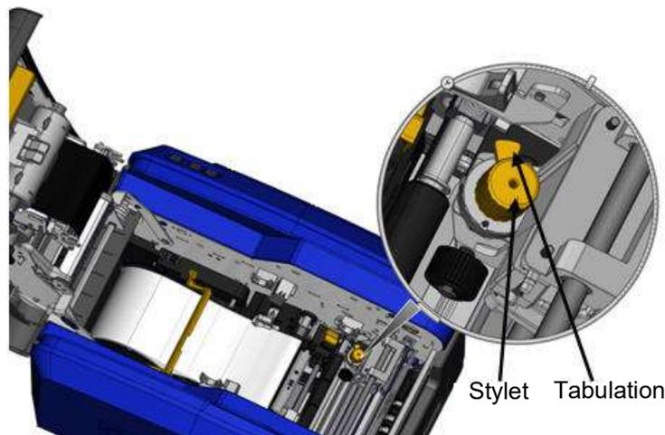
Différents consommables d'étiquettes demandent différentes hauteurs de lame. Lorsque vous appuyez sur le bouton Imprimer, un message apparaît, indiquant si le média installé peut être coupé. Si c'est le cas, un autre message apparaît indiquant la hauteur de lame à utiliser (hauteur 1 ou 2). Pour régler la hauteur de lame :
