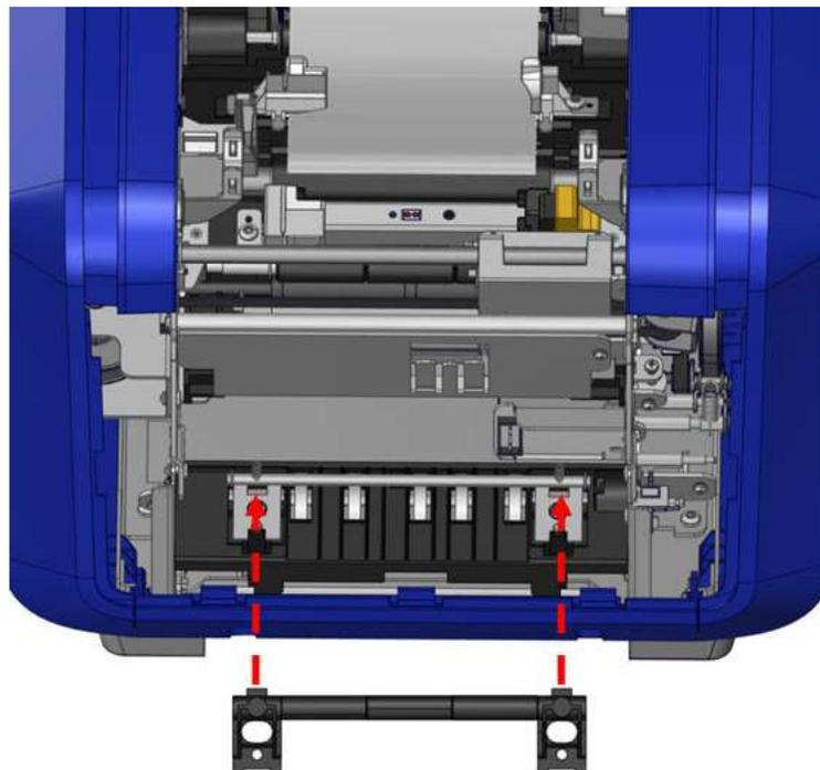
9. Pour remettre en place le panneau gris, accrochez les trois boucles au bas du panneau au-dessus des languettes bleues de l'imprimante, puis poussez le panneau en place vers le haut.
