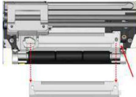
8. Utilisez un linge de nettoyage humecté du kit de nettoyage pour nettoyer le coussinet de découpe.
