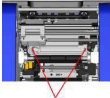
7. Tirez doucement sur la languette pour dégager le coussinet de découpe, puis sortez le coussinet de découpe du dessous du chariot du massicot XY pour le retirer.
