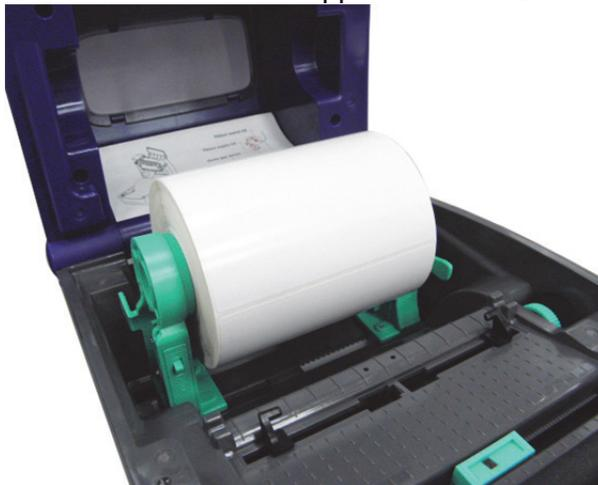
4. Mettez le commutateur du verrou du support de média en position **Lock (Verrouiller)** (vers le bas) pour maintenir le rouleau d'étiquette fermement en place.
