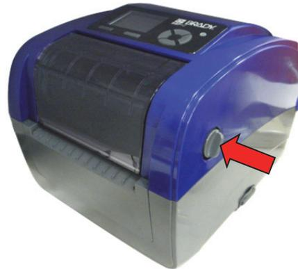
2. Un support du couvercle supérieur à l'arrière de l'imprimante s'engagera dans le couvercle inférieur pour maintenir le couvercle supérieur de l'imprimante ouvert.
