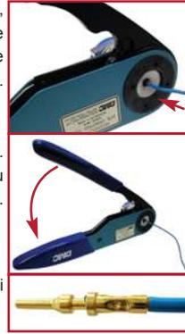
Sertir ensuite en refermant à fond les deux branches de la pince jusqu'à sa réouverture. Vérifier visuellement que le contact est correctement sertit : le fil doit être visible par le trou d'évent et l'isolant du fil doit être appliqué contre l'arrière du contact.
