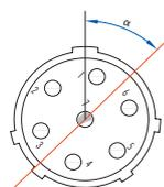
Rotation de l'isolant par rapport au type „normal“
