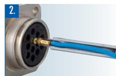
2. Positionner le fil et le contact sertis dans la gouttière de cette lame. Insérer l'ensemble par l'arrière de l'embase ou de la fiche, en commençant du centre de l'isolant vers l'extérieur, dans le logement destiné à recevoir le contact, en fonction de votre plan de câblage. Enfoncer jusqu'à ce que la lame vienne en butée. Retirer la lame. Vérifier la mise en place correcte des contacts en exerçant une légère traction sur chaque fil.
