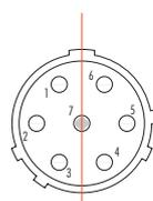
Clé principale identique au type „normal“, décalage angulaire des clés secondaires
