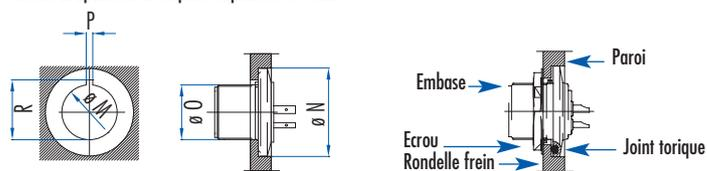
Après avoir effectué les perçages dans la paroi, placer le joint torique dans la gorge de la collerette de l'embase. Placer ensuite l'embase, la rondelle frein puis pour terminer l'écrou.
