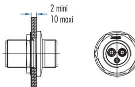
Après avoir effectué les perçages dans la paroi, placer le joint torique dans la gorge de la collerette de la traversée. Placer ensuite la traversée, la rondelle frein et pour terminer l'écrou. L'étanchéité du montage est obtenue par écrasement du joint entre la paroi et la traversée.
