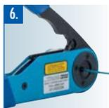
Après avoir dégainé le câble et dénudé les fils (se référer à la partie „dénudage des contacts“), réglé la pince (se référer à la partie „réglage de la pince“ ci-contre), introduire la partie dénudée du fil dans le fût d'un contact, s'assurer par le trou d'évent qu'elle pénètre entièrement. Ouvrir entièrement la pince. Insérer complètement l'ensemble formé par le contact et le fil dans l'orifice prévu au dos de la pince.
