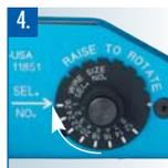
Enlever l'épingle de sécurité. Soulever le bouton de sélecteur et tourner le pour amener le chiffre choisi en face de la marque d'indexation. (Pour savoir quel chiffre choisir utiliser le tableau ci-contre ou la plaque d'instruction de la pince.)
