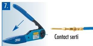
Sertir ensuite en refermant à fond les deux branches de la pince jusqu'à sa réouverture. Vérifier visuellement que le contact est correctement sertit: le fil doit être visible par le trou d'évent et l'isolant du fil doit être appliqué contre l'arrière du contact.
