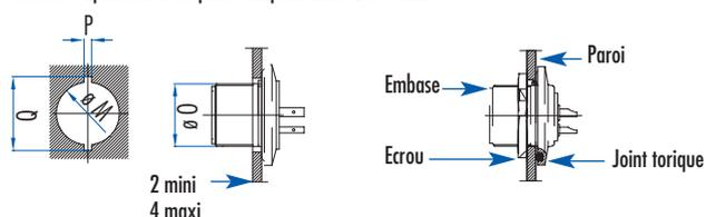
schéma 2: Epaisseur de la paroi supérieure à 4 mm
