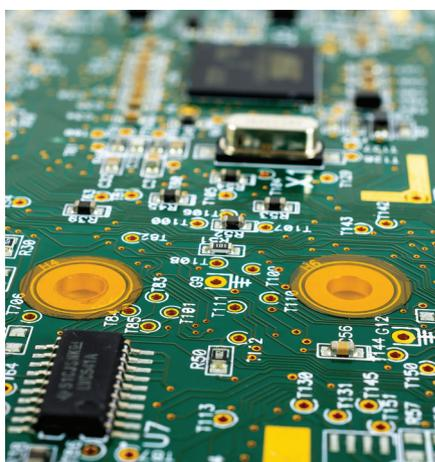
Le film de masquage B-7634 de Brady Corporation pour les cartes de circuits imprimés offre une excellente protection lors des processus de fabrication de composants électroniques, tels que le brasage à la vague et le nivelage à l'air chaud. Le film de masquage en polyimide est idéal pour la pose automatique et peut être retiré proprement.
