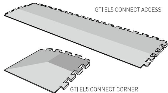
Ces accessoires nécessitent d'être collés avec une colle réactive Bi composants PU, et lestés pendant la prise de la colle (6 à 12 heures), ou avec une colle contact en phase aqueuse, par double encollage.
